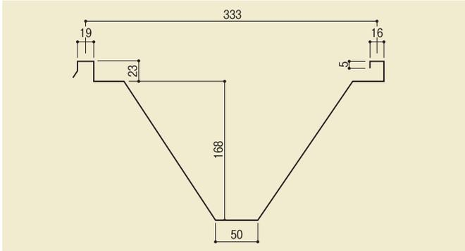
ラッキーワイド1は施工が簡単でしかも接合部の巻き馳により、完全密着するボルトレス工法です。雨漏りはもとより、スバ漏りの問題も解決しました。また厚番手使用により、積雪地域における荷重にも耐えられ、安心して採用できます。
